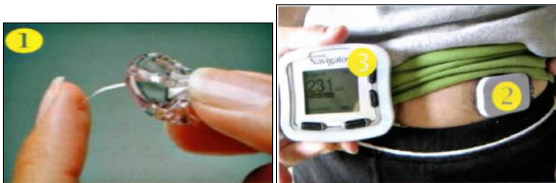
Figure 3 : CGM (1 = capteur de glucose, 2 = émetteur (radio-fréquence), 3 = récepteur).
