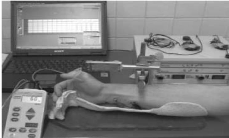
**Figure 22** : Mécanomyographe
