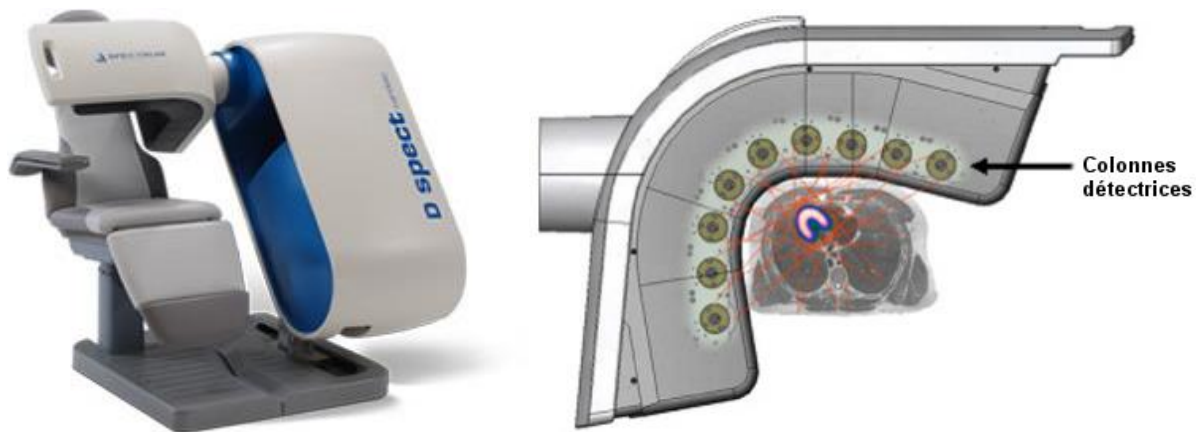
Figure 2 : Caméra D-SPECT : 9 colonnes détectrices permettant un échantillonnage tomographique complet de l'aire cardiaque
