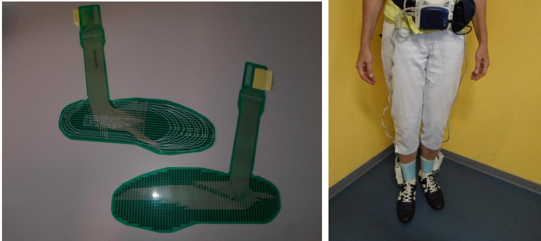
Figure 1: Dispositif matériel du système F-Scan® : semelles embarquées comportant des capteurs résistifs, boîtiers d'interface fixés aux chevilles, boîtier d'acquisition relié à la ceinture
