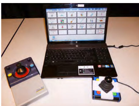
Plaphoons sur PC en mode souris avec deux types de joysticks différents
