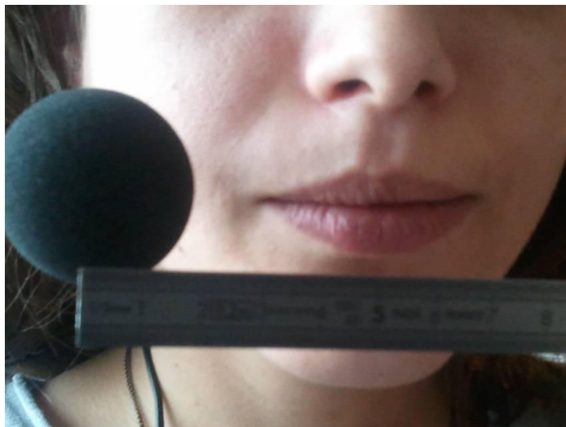
Placement du micro à 5 cm du point médian des lèvres du chanteur.
