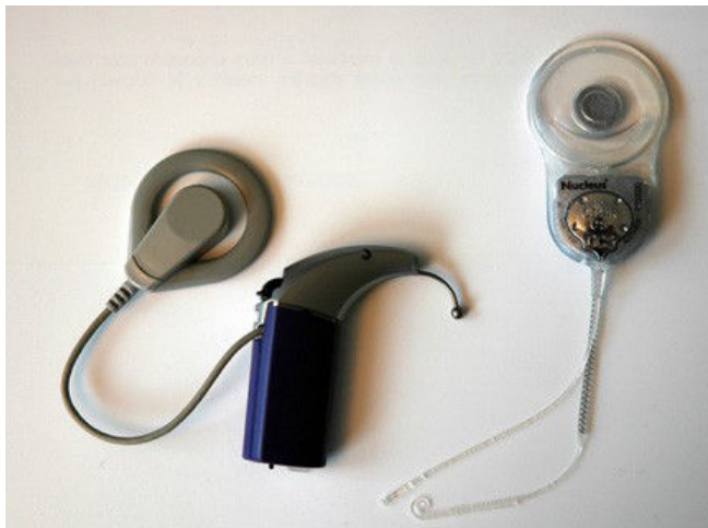
Figure 4 – Photo des parties interne et externe d'un implant cochléaire
