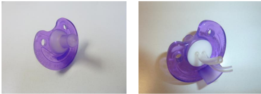
Photographie 2 : Tétine munie de capteurs
