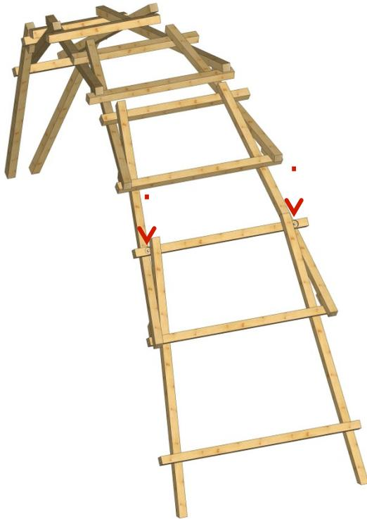
Fig. 17 : Boulonnage arches
