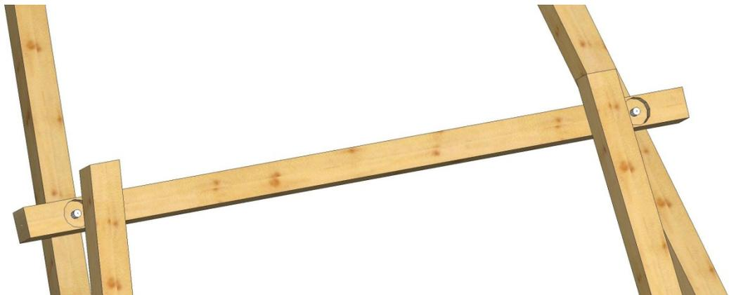
Fig. 18 : Détail boulonnage arches
