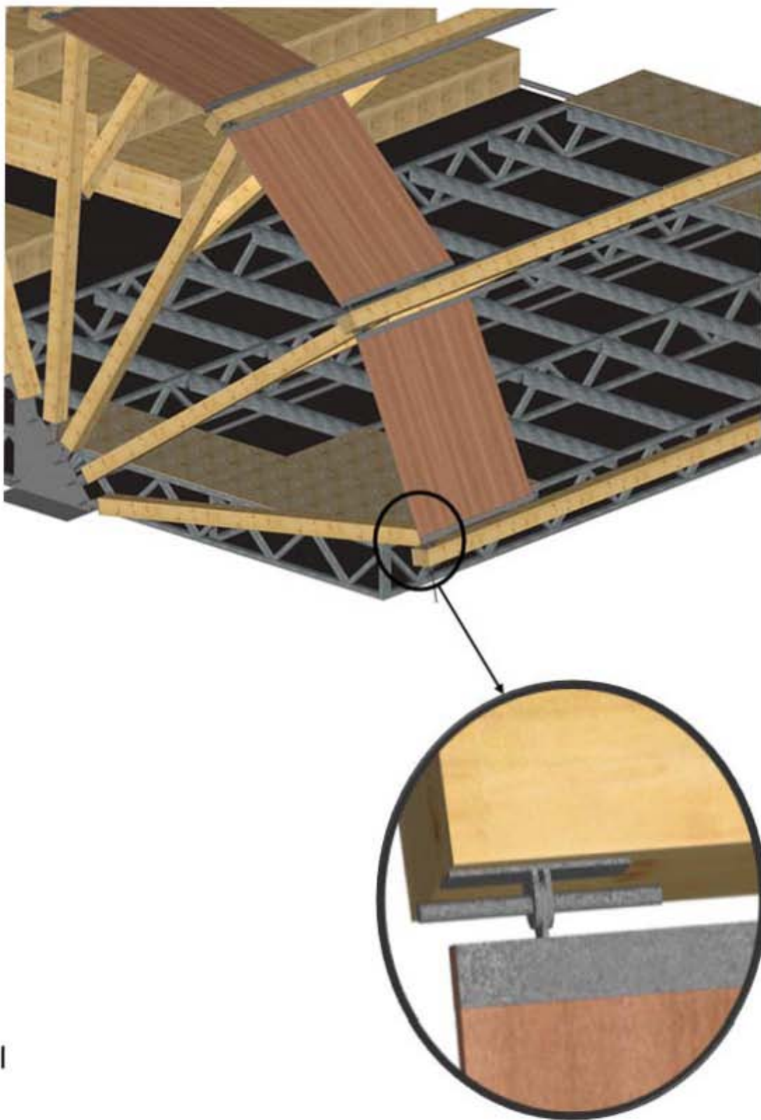
Assemblage des panneaux sur les portiques par ferrures métalliques.
