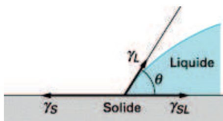
Figure 38 : Mouillage d'une goutte de liquide sur un solide.
