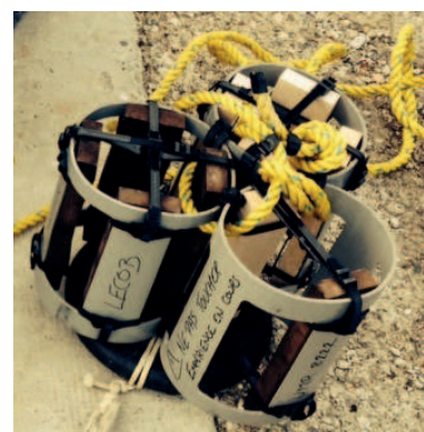
Figure 44 : Éprouvettes de hêtre furfurylées avant immersion.
