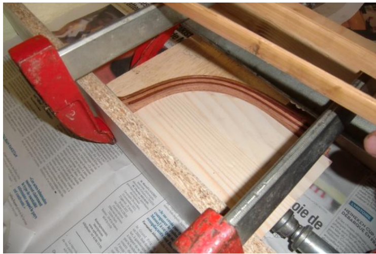
Figure 32: Montage d'usinage pour le ceintrage du frein
