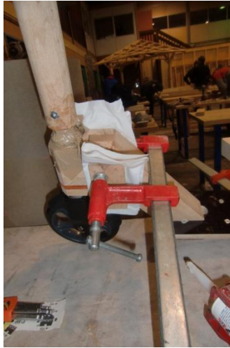
Figure 31 : Assemblage du lien au tube de direction via des tourillons et de la colle
