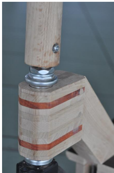
Figure 33 : Assemblage final entre la fourche, le tube de direction et la colonne de direction
