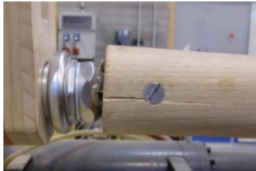
Figure 43 : Fissure apparue lors du troisième essai
