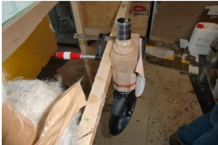
Figure 30 : Montage d'usinage pour le collage de la fourche et de la colonne
