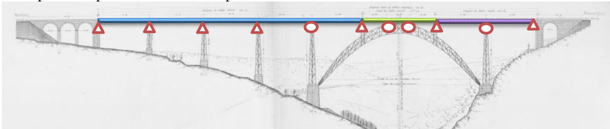
Figure 1 : Modélisation des appuis du tablier
