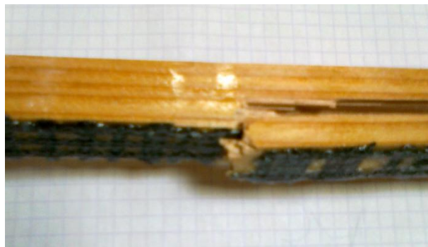
Figure 14 : Illustration du cisaillement dans l'éprouvette
