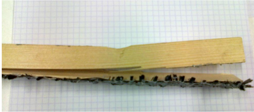
Figure 21 : Illustration de la rupture de la fibre inférieure du bois au dessus du joint de colle
