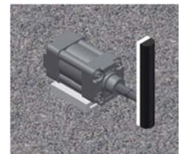
Figure 42: Vérins pneumatiques utilisés pour le maintien des pièces
