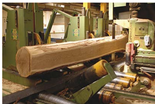
Figure 23: Bloc de scie de tête permettant le délignage des grumes
