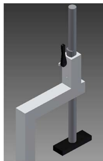
Figure 53 Pince de serrage en liaison glissière
