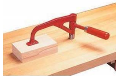
Figure 25 : Maintien par valet d'une pièce de bois sur un établi
