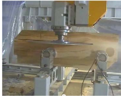
Figure 18 : Maintien par vérins sur bois massif (Ce sont des vérins pas des ventouses)
