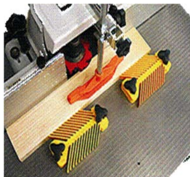
Figure 29: Dispositif de blocage de la pièce par aimant sur une table, les cales peuvent être activé ou désactivé par la manette sur le dessus
