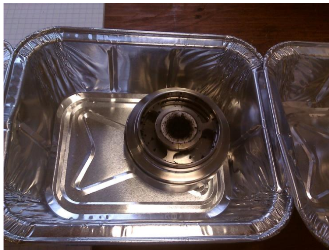
Figure 36 : Particules recueillies sur le plateau de collection PM 2,5
