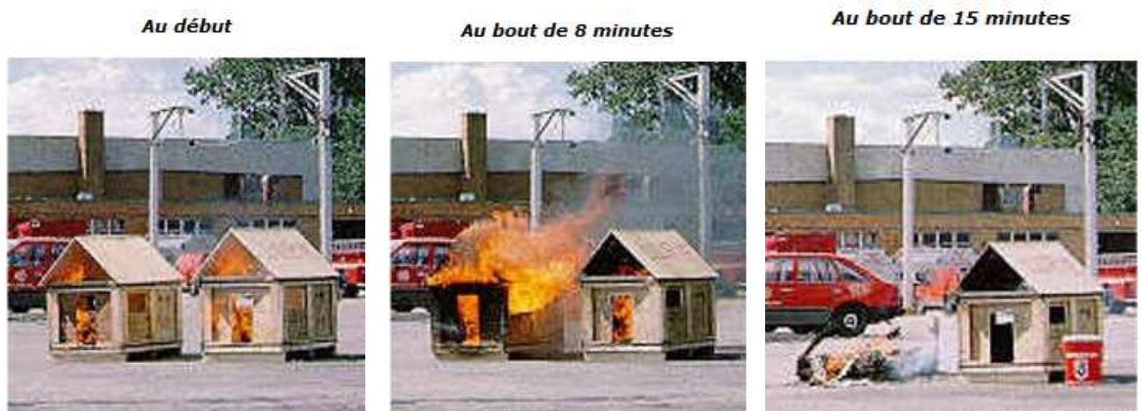
Figure 32 : Démonstration de l'efficacité d'une peinture intumescente par rapport à une peinture latex. Source : www.protectionincendie.com
