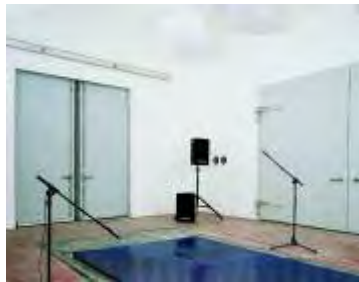
Figure 6 Salle réverbérante du Pôle acoustique du Centre de Transfert de Technologie du Mans
