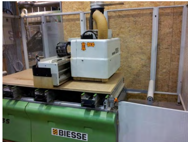
Figure 42 L'usinage des panneaux perforés
