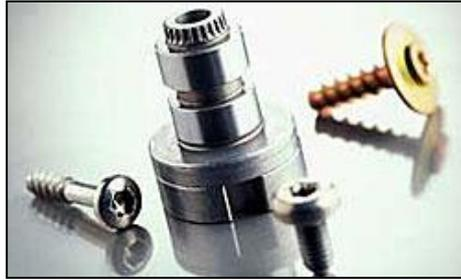
*Image 2 : Exemples de pièces réalisées par le procédé de frappe à froid. [2]*
