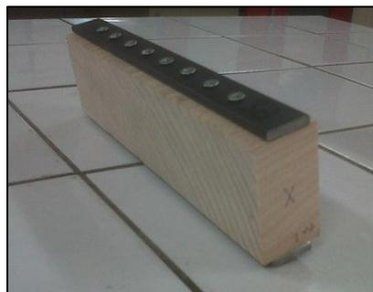
*Image 5 : Photo d'un échantillon avec vissage linéaire*
