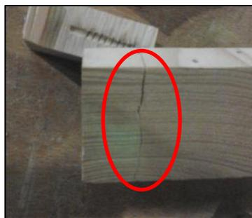
*Image 8 : Photo des fissures apparues lors du premier essai de montage*
